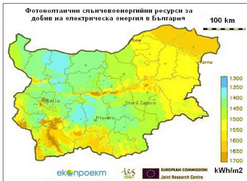
Фигура 28 Годишна сума на слънчевата радиация в Р България и оптимален наклон на фотоволтаичните модули
